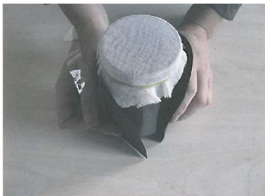
圖 22 及圖 23：以黑色色紙包覆玻璃罐，避免光線直射。黑色色紙應能隨時取下以利觀察。
